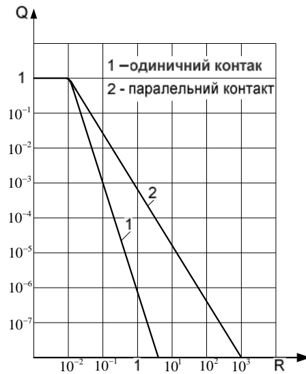
Рисунок 1 - Залежності ймовірності відмови контактів від опору
