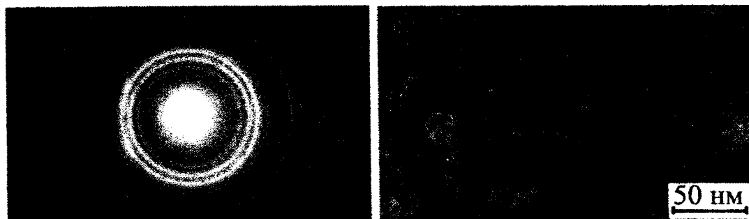
Рис.1. Електроннограма та кристалічна структура двошарової плівки Pd(4)/Fe(18)/П. В дужках товщина вказана в нм
