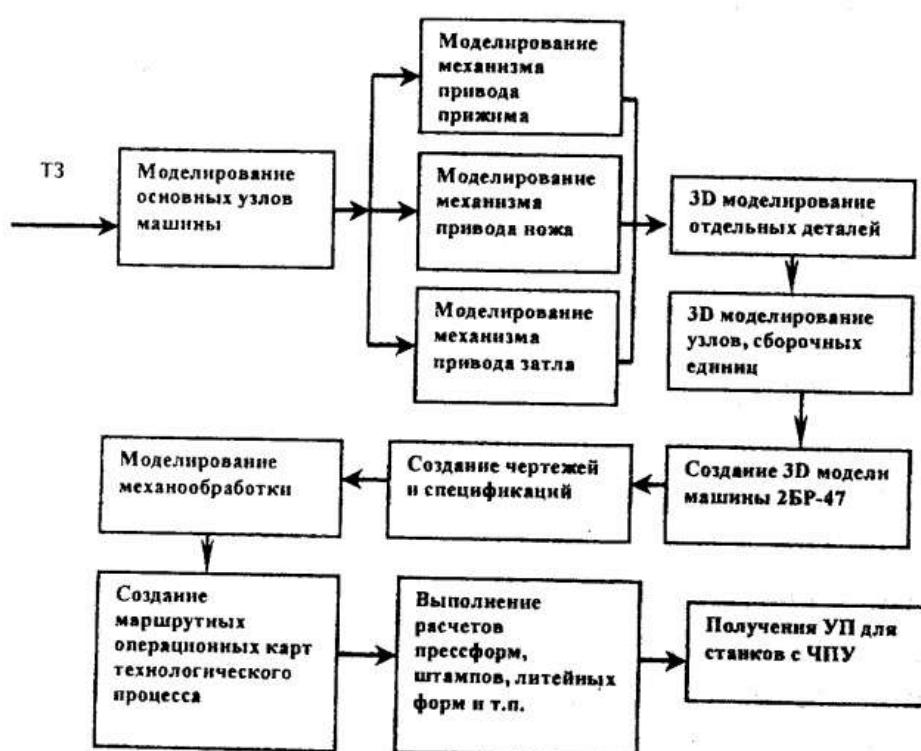
Рис. 1 - Структурная схема системы автоматизированного проектирования (САПР) малоформатной бумагорезальной машины модели 2БР-47 (новое название PROGRESS-47)
