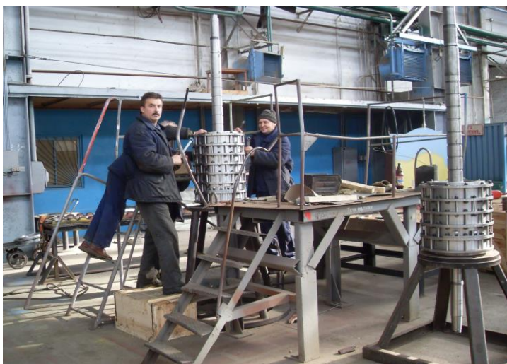
Рисунок 2 – Вертикальная сборка выемной части подпиточного многоступенчатого насоса АЦНА 60-185 для АЭС с использованием нагрева рабочих колес.
