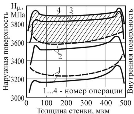
Рисунок 3 – Распределение микро- твердости (степени деформации) по сечению стенки изделий из стали 12X18N10T: — — — — — многопереходная вытяжка с покрытием; - - - - - вытяжка без покрытия; /// - - - - - необходимость отжига заготовки без покрытия (3 – 4 переходы)
