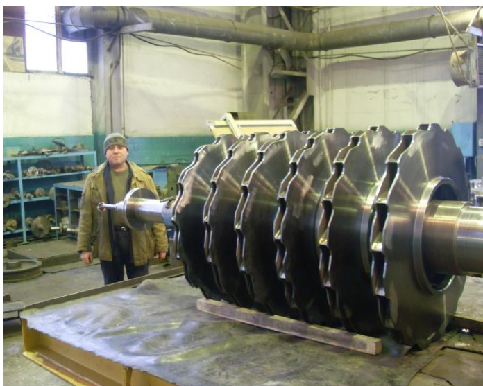
Рисунок 1 - Многоступенчатый ротор высокооборотного центробежного компрессора газоперекачивающего агрегата.
