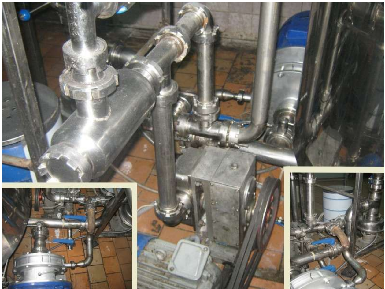
Рисунок 17. – Фото агрегата-гомогенізатора в технологічній лінії Комаровського молочного заводу.
