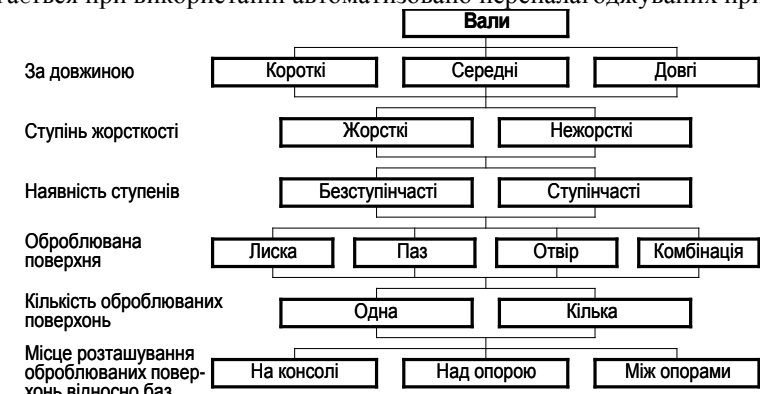
Рис. 1. Класифікація валів, що обробляються на свердильно-фрезерно-розточувальних верстатах
