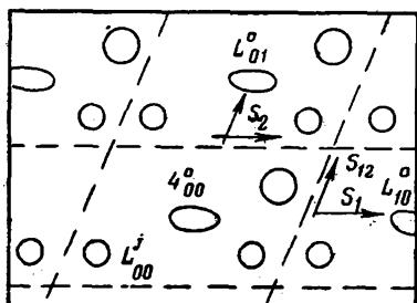
Главный вектор внешней нагрузки на  $L_{00}^j$  ( $j = 0, 1, \dots, k - 1$ ) считаем равным нулю. В этих условиях распределение напряжений в решетке носит двоякопериодический характер.
