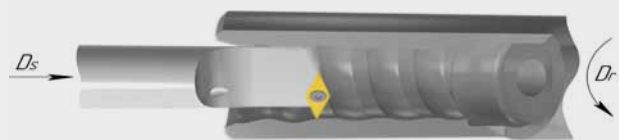
↑ Рис. 9. Модель построчного точения стандартным резцом
