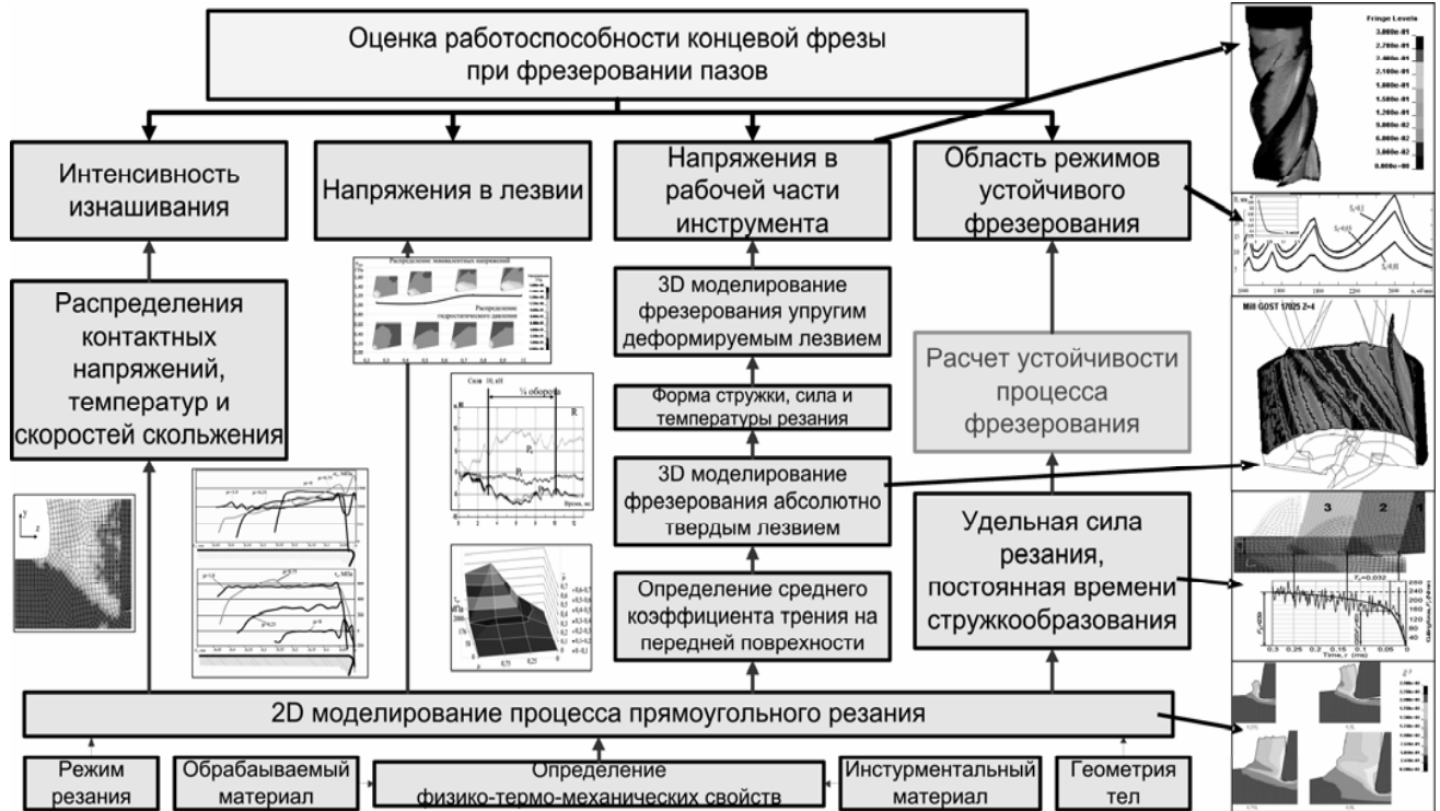
Рисунок 7.2 – Концепция оценки работоспособности инструмента на стадии его проектирования на примере концевой фрезы
