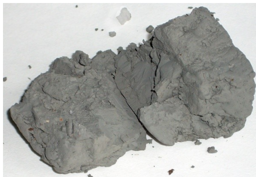
Рисунок 4.1 – Фотографії зовнішнього вигляду ТВ виробництва титан(IV) оксиду пігментного
