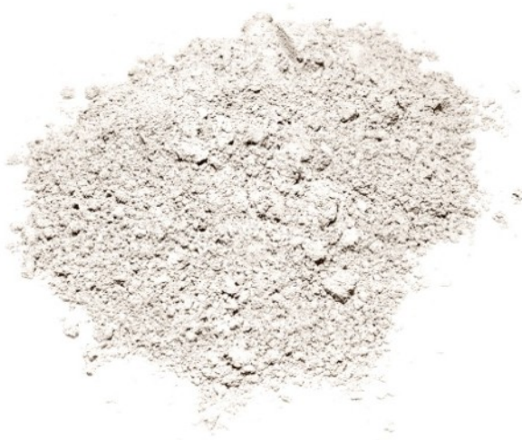
Рисунок 4.12 – Зовнішній вигляд отриманого продукту титан(IV) оксиду
