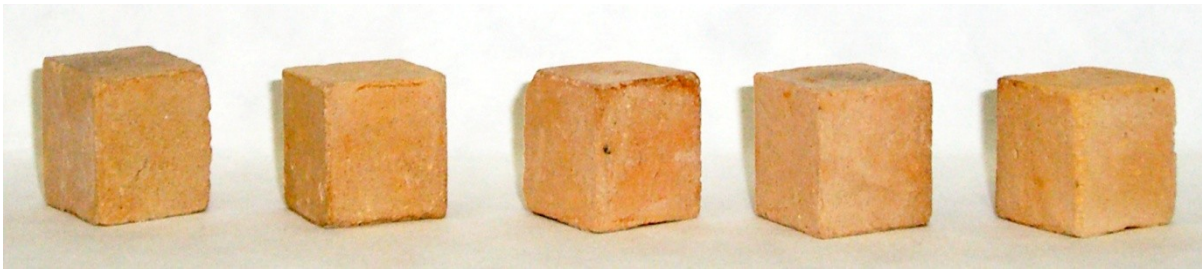
Рисунок 5.5 – Зовнішній вигляд зразків сформованих кубиків (розмір 2х2х2 см)
