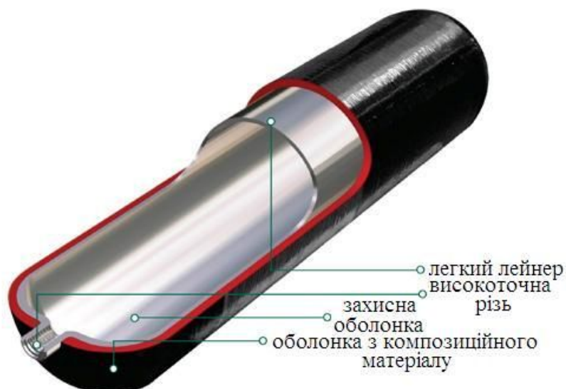
Рис. 1.3. Типова конструкція металопластикового балона високого тиску з армуючою оболонкою всієї поверхні (СПГ–3)
