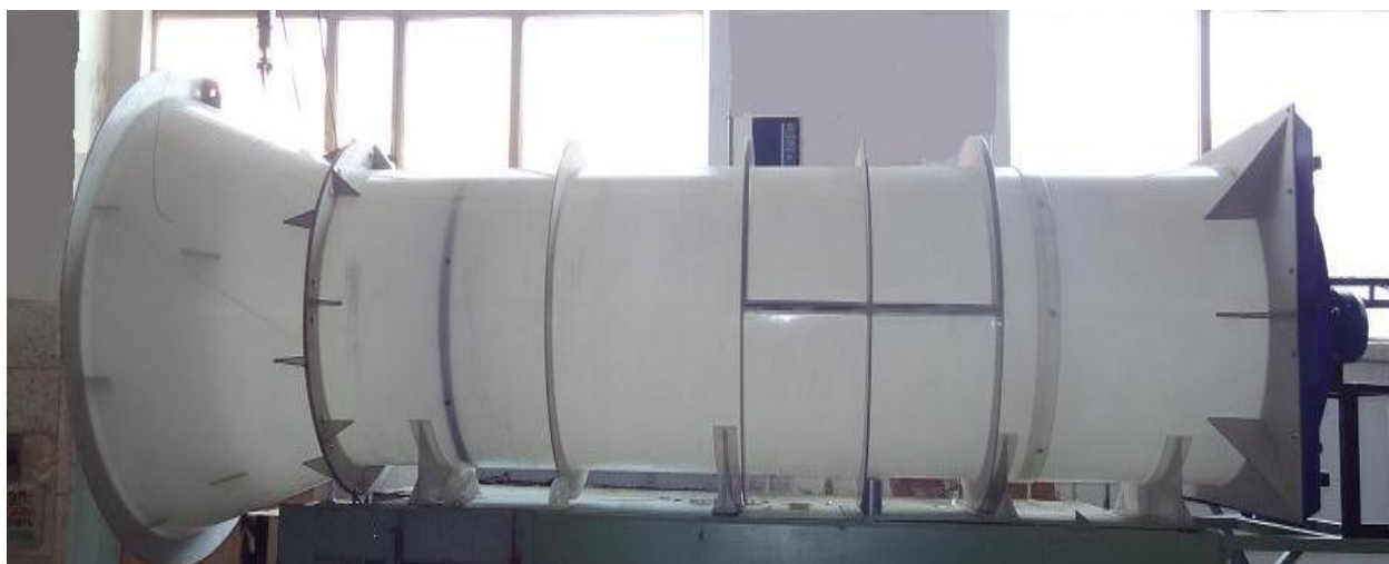
Рисунок 57 – Змонтована аеродинамічна труба
