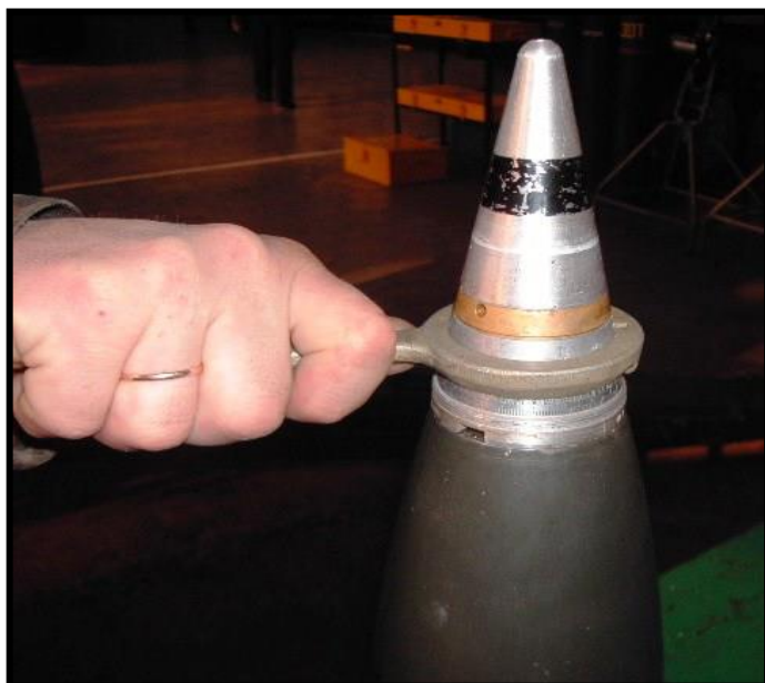
Рисунок 4.6 – Установка підривника Т-7
