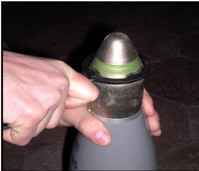
Рисунок 4.16 – Згвинчування гермоковпака ключем ЗИ38
