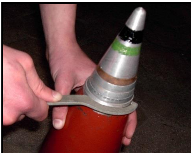
Рисунок 4.30 – Догвинчування підривника Т-7
