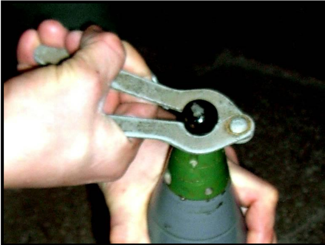
Рисунок 4.3 – Згвинчування ковпачка за допомогою лещат
