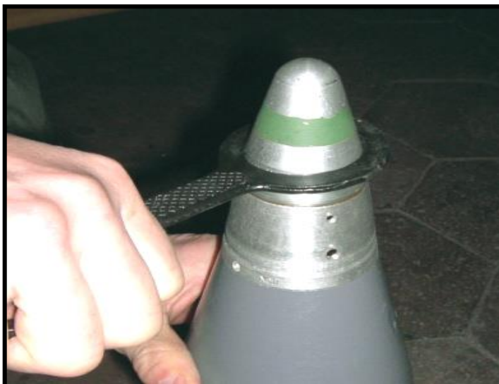
Рисунок 4.20 – Установка ключа 9Ф371 на пiдривник
