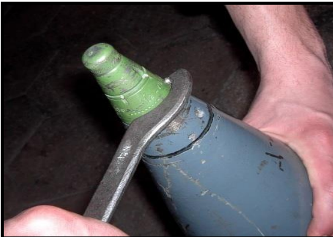
Рисунок 4.26 – Догвинчування підричника РГМ-2
