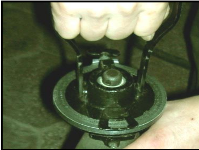
Рисунок 4.11 – Установка ключа ЗИЗ6 на підричник
