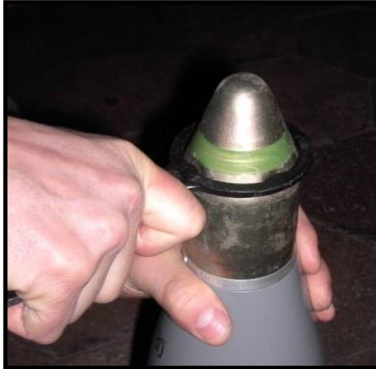
Рисунок 4.8 – Згвинчування гермоковпака ключем 42-78
