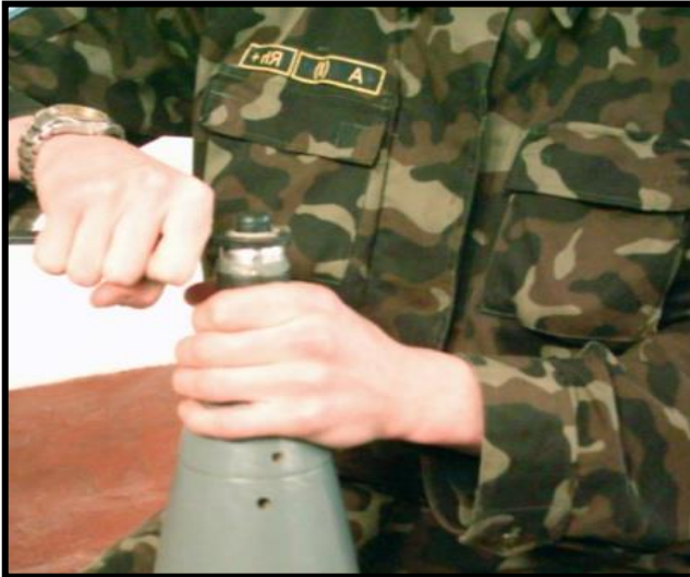
Рисунок 4.13 – Суміщення поділки шкали на головній втулці
