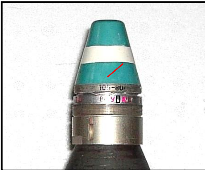
Рисунок 4.24 – Заводська установка підричника AP-5
