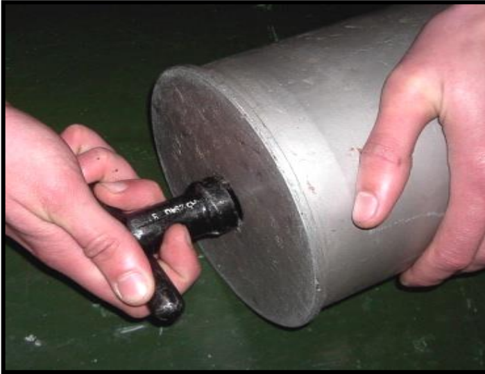
Рисунок 4.33 – Догвинчування капсульної втулки
