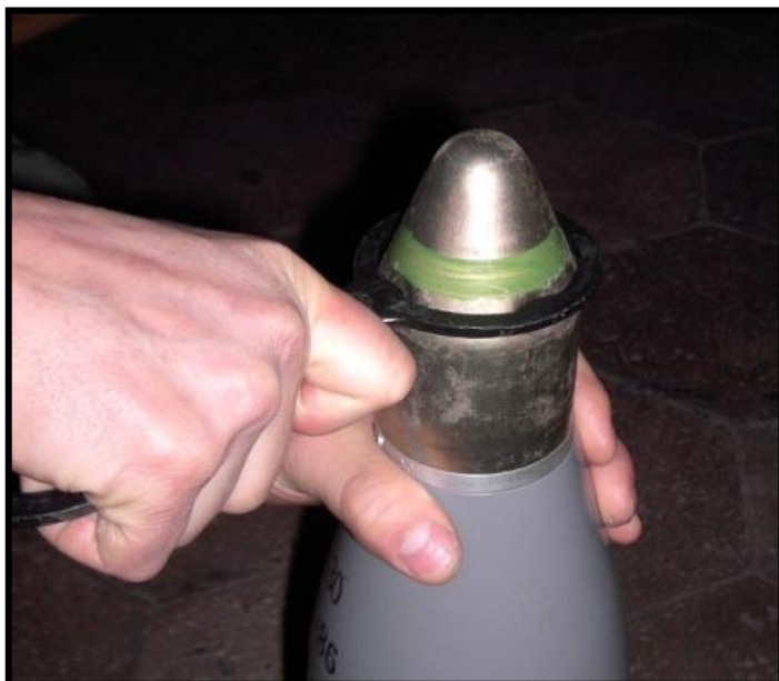
Рисунок 4.19 – Згвинчування гермоковпака ключем 9Ф371
