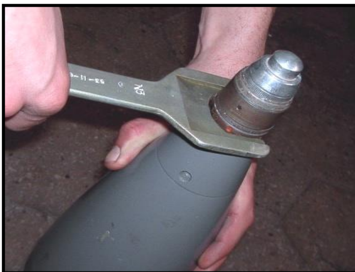
Рисунок 4.28 – Догвинчування підричника В-90
