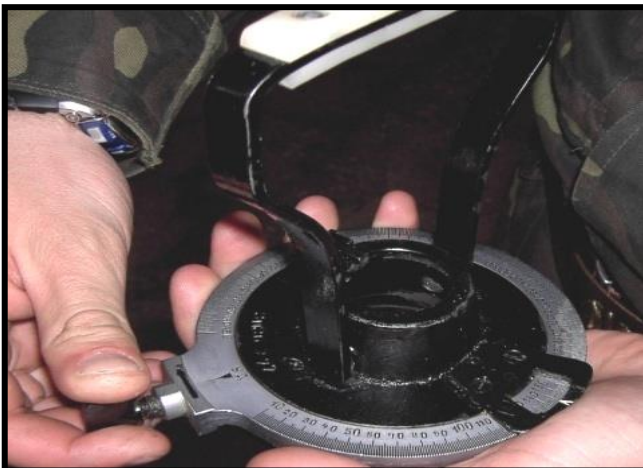
Рисунок 4.10 – Закріплення візирної планки гвинтом
