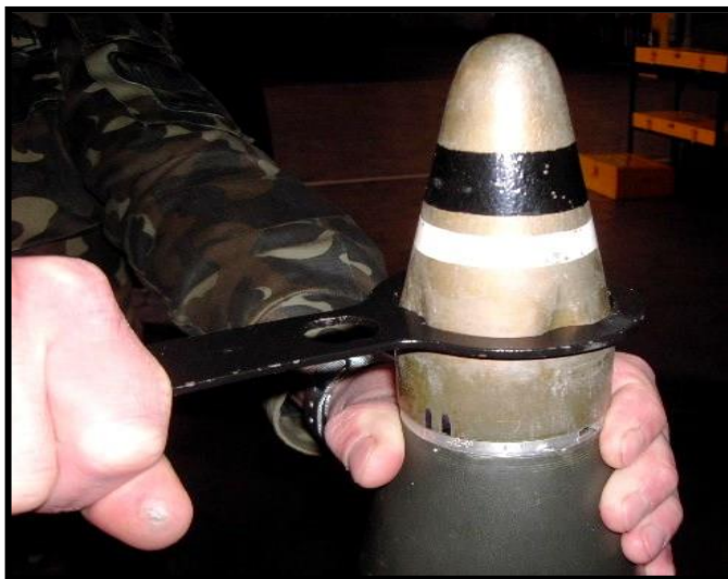
Рисунок 4.5 – Згвинчування запобіжного ковпака ключем 42-78
