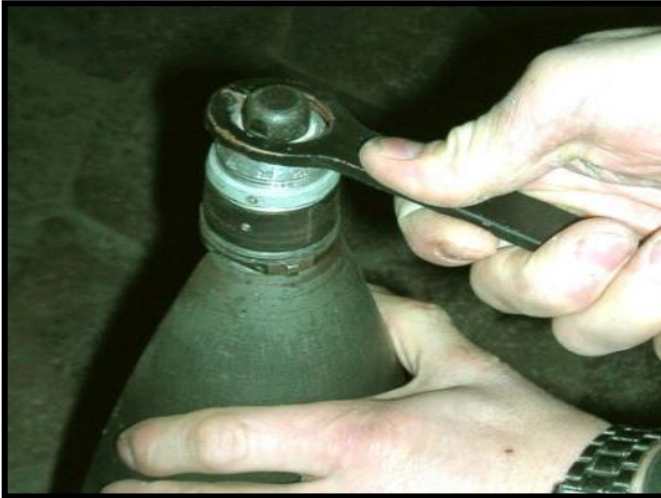
Рисунок 4.12 – Установка ключа ЗИ37 у паз головної втулки
