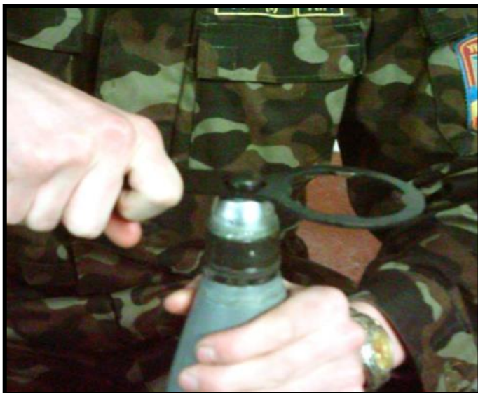
Рисунок 4.14 – Згвинчування установлювального ковпачка
