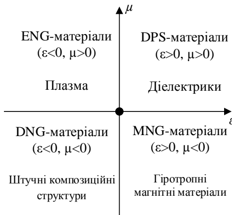
Рисунок 1 – Класифікація фізичних матеріалів в залежності від значення діелектричної і магнітної проникності
