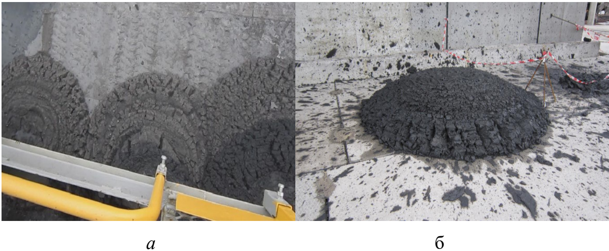
Рисунок 5.8 – Вигляд осаду центрифуги ОГШ 461Л-01 на промисловому майданчику (середня вологість 30%): а – вид зверху; б – вид збоку.
