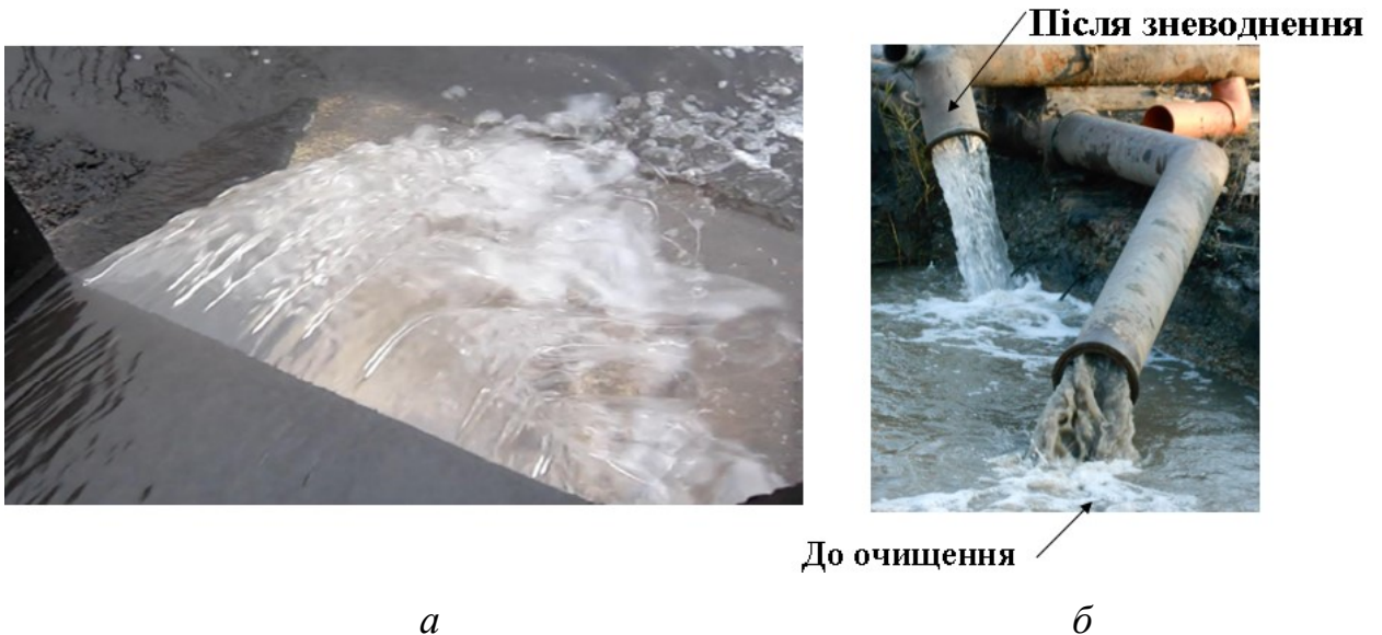
Рисунок 5.9 – Вигляд освітленої води: а – після гравітаційного осадження в тонкошаровому відстійнику; б – після зневоднення на центрифугах ОГШ 461Л-01.
