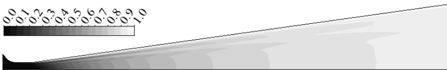
Рисунок 1 – Об'ємний паровміст у потоці рідини, що закипає
