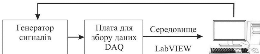
Рисунок 1 – Блок-схема для аналізу сигналу
