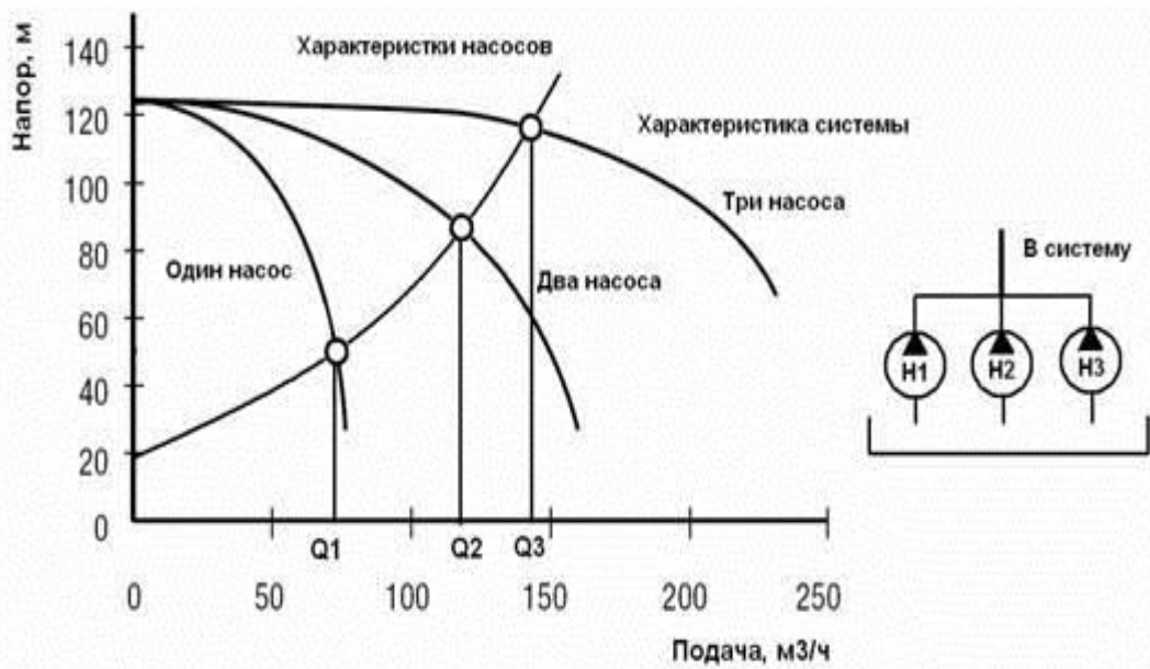
Рисунок 8.23 – Каскадне регулювання режиму роботи насосної станції при роботі на мережу з переважно динамічною складовою
