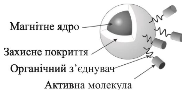
Рисунок 1.4 – Схематичне зображення функціоналізованої магнітної наночастинки. Із роботи [22]
