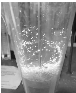
Рисунок 3.42 – Класифікація гранул за масою в робочому просторі вихрового гранулятора
