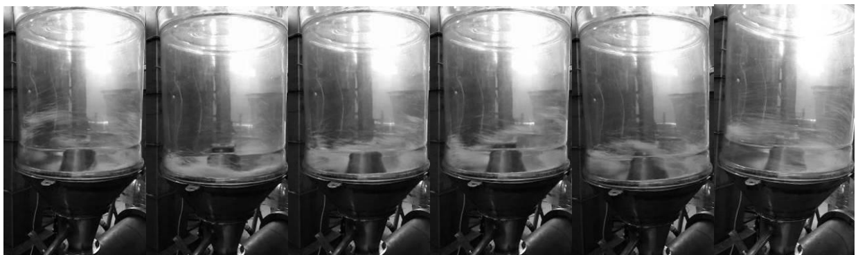
Рисунок 3.40 – Вихід гранулятора з циліндричною камерою на робочий режим (зміна траєкторій руху гранул), класифікація гранул
