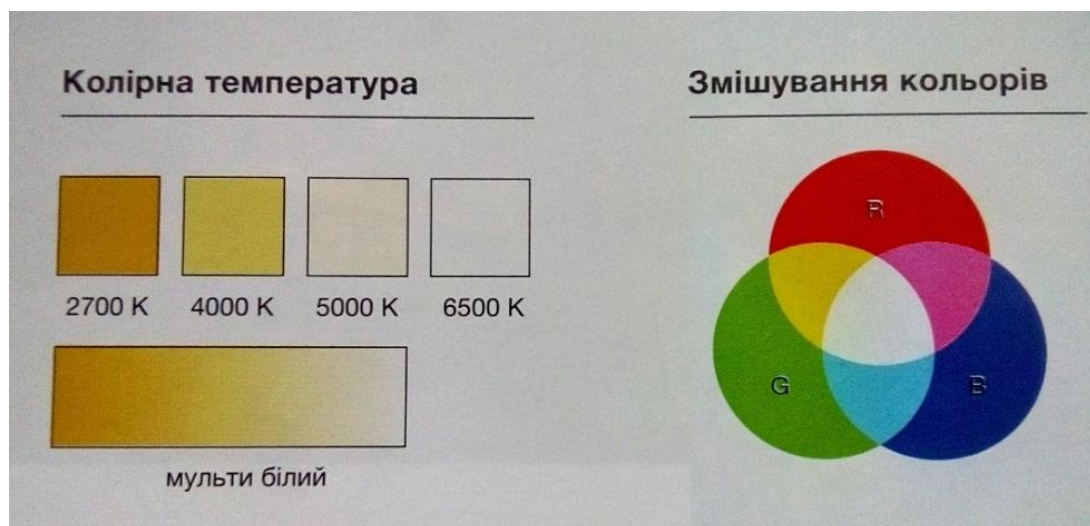
Рисунок 27 – Колірна температура та кольори світлодіодів
