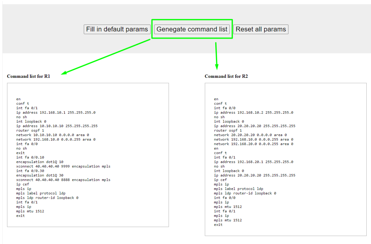
Рис. 3.4. Виведення команд налаштування роутерів
