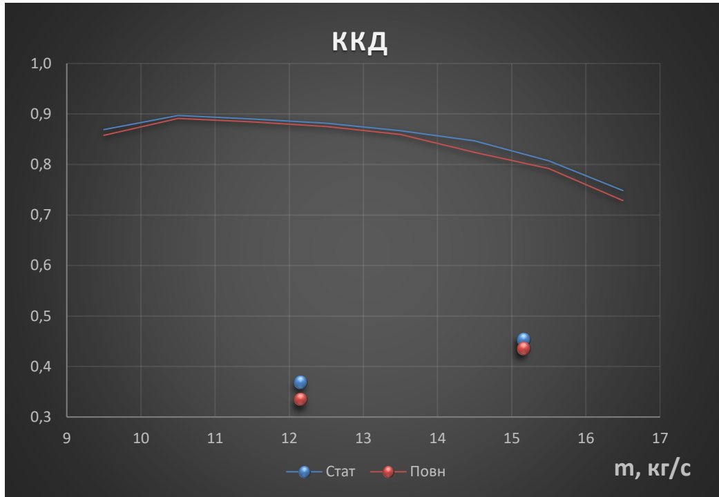
Рисунок 7.8 – Характеристика політропного ККД 6 ступеню за статичними та повними термодинамічними параметрами в залежності від масової витрати
