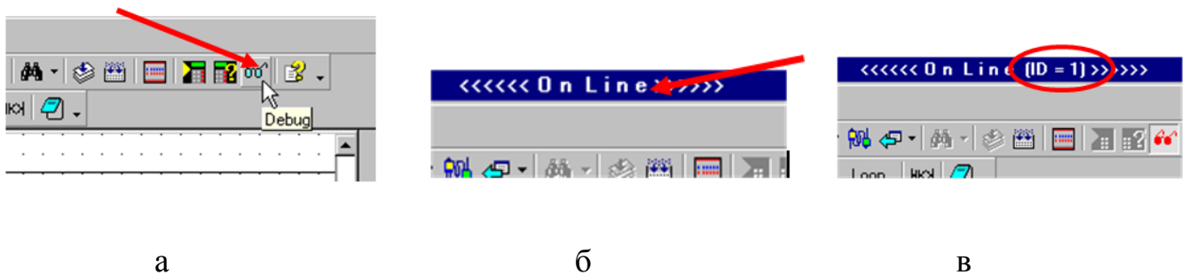
Рис.2.3. Налаштування проекту в ПЛК Unitronics M90 [15]: а – завантаження програми; б – діагностика помилок; в – діагностика роботи в мережі
