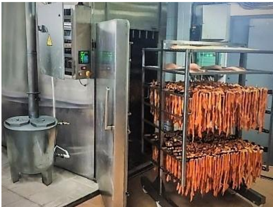
Рисунок 2 Промислова коптильна установка
