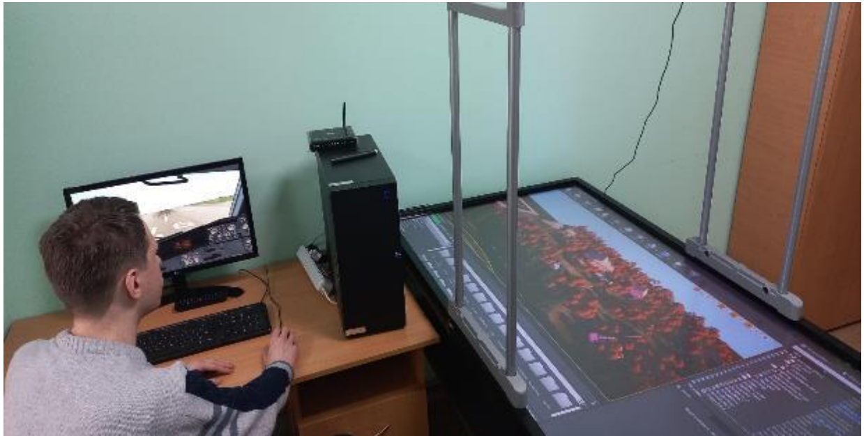
Рисунок 3.2 – Фото стенду-симулятора для машинного навчання автономного БПЛА
