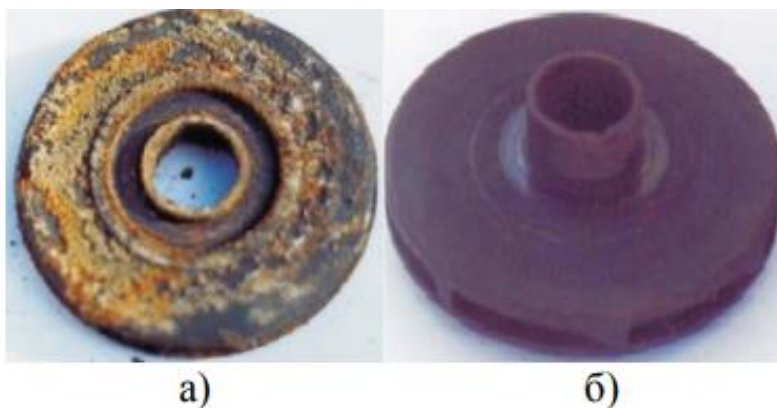
Рисунок 4.5 – Вигляд колеса до (а) та після (б) гідродинамічний кавітаційного очищення
