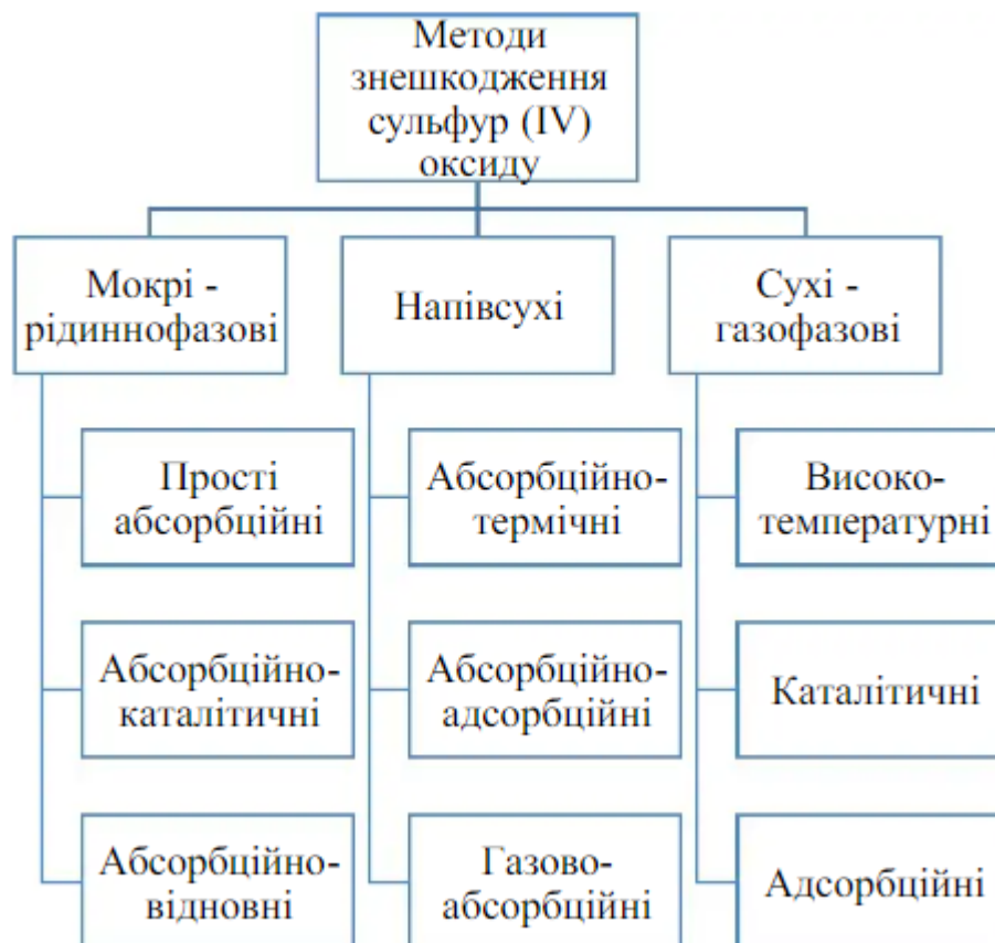
Рисунок 4.22 – Класифікаційна схема процесів десульфуризації відхідних промислових газів
