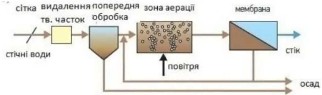
Рисунок 4.15 – Схема очищення стічних вод із використанням мембранного біореактору (МБР)
