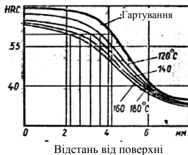
Рисунок 6 - Зміна твердості по глибині цементованого шару сталі 20X2H4A залежно від температури відпуску
