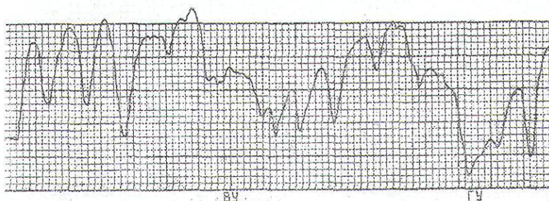
Рисунок 1 - Профилограмма поверхности сплава Т14К8 после алмазного шлифования (ГУ 500, ВУ 20000)
