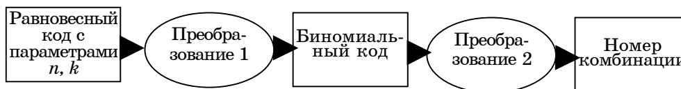
Рисунок1 -- Преобразование равновесного кода в двоичный номер
