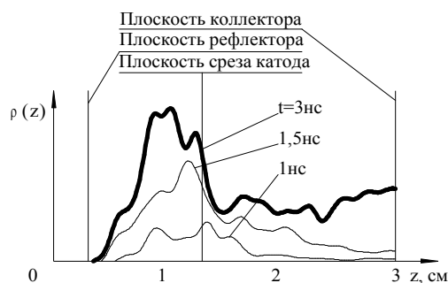
Рисунок 2 – Распределение плотности заряда \rho(z) по продольной координате для роста ( t = 1\text{нс} ), спада ( t = 1,5\text{нс} ) и стационарной части ( t = 3\text{нс} ) импульса напряжения между катодом и анодом
