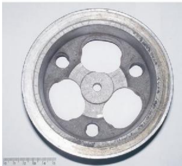
Рисунок 2 – Внешний вид характера разрушения корпуса клапана а – со стороны насоса; б – со стороны трубопровода
