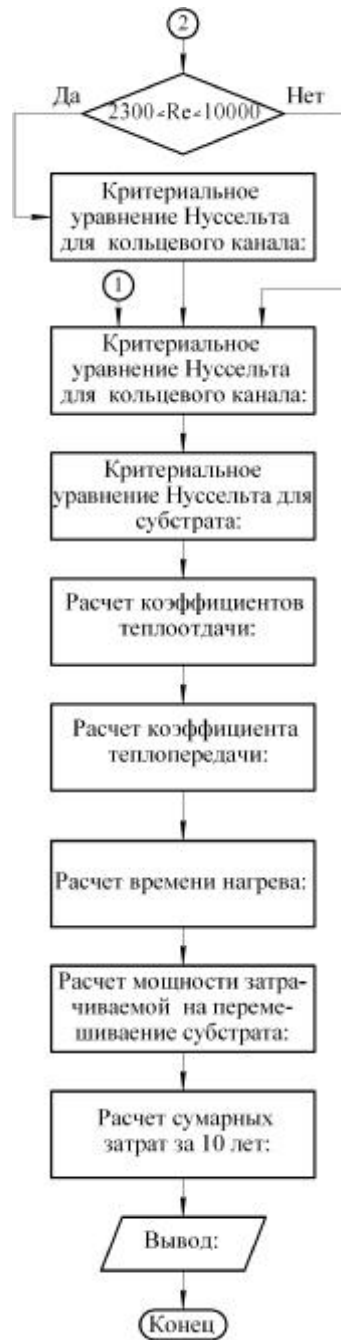
Рисунок 4 – Продолжение блок-схемы расчета подготовителя-подогревателя
