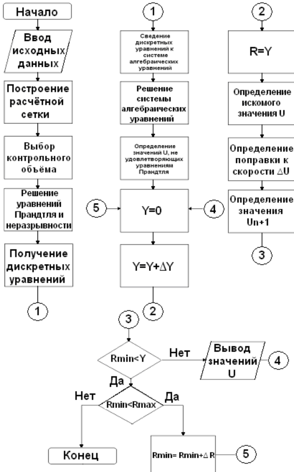
Рисунок 3 - Алгоритм расчёта составляющих скорости закрученного газового потока в рабочем пространстве вихревого гранулятора
