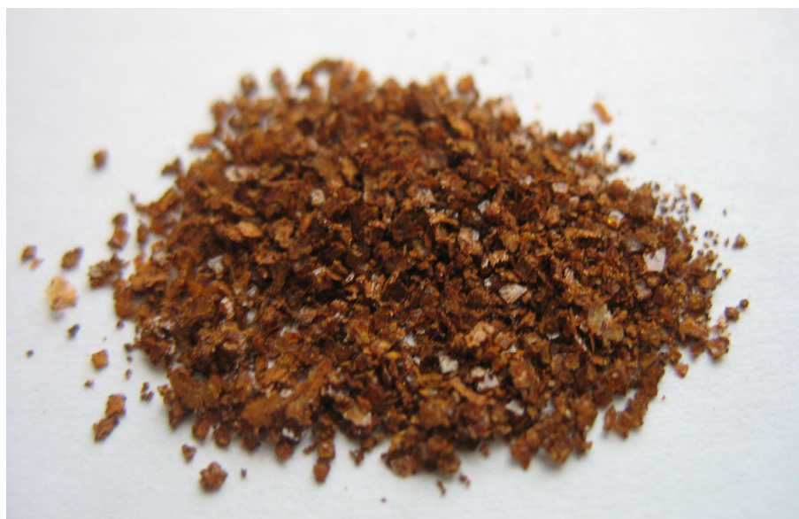
Рис. 3.12. Фото висушеного осаду, отриманого при електрокоагуляційному очищенні хромовмісних стічних вод гальванічного виробництва (масштаб 1:100)
