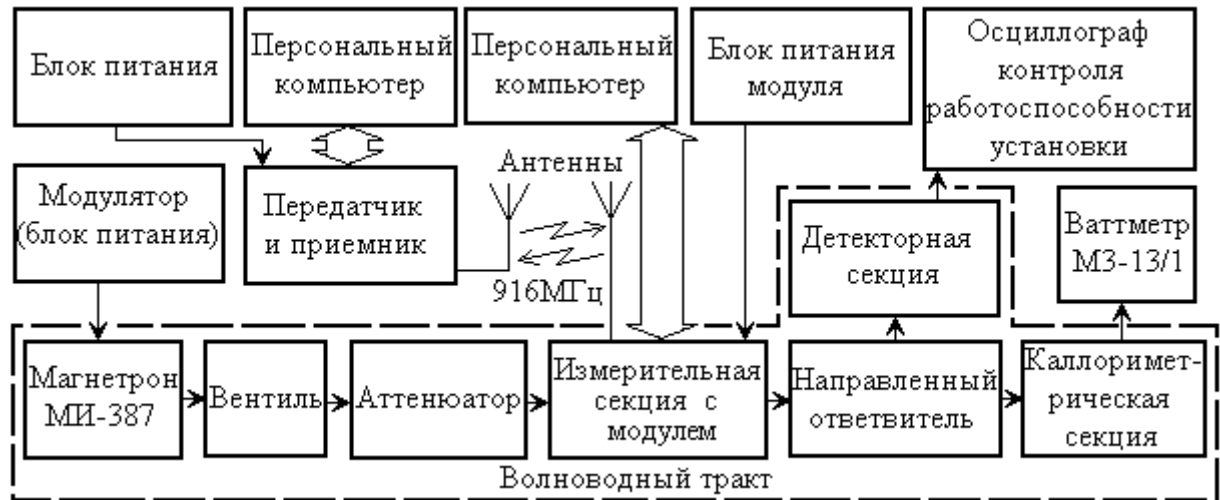
Рис. 2.15. Структура установки для исследования воздействия ВИИЭМП на модули приемников и передатчиков
