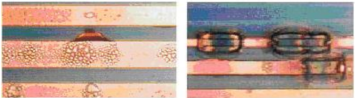
Рис. 1.5. Тепловое разрушение медных линий при воздействии статического электричества [16]
