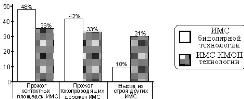
Рис. 1.3. Статистическое распределение функционально значимых МСЭ, выход которых из строя привел к отказам ИМС при воздействии ИЭМП
