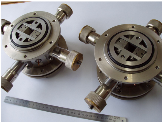
Рис. 4.6. Общий вид объектного и углового коллиматоров
