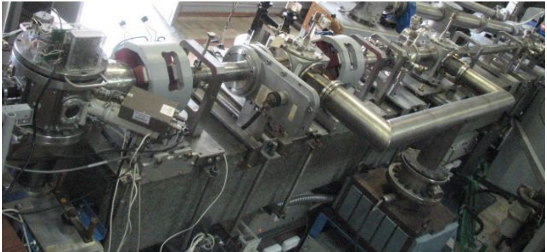
Рис. 4.1. Общий вид зондоформирующей системы экспериментальной установки ядерного сканирующего микрозонда [90]
