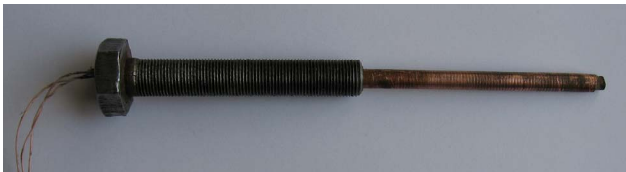
Рис. 3.6. Зовнішній вигляд зонду для вимірювання температури у рідинному кільці РКМ
