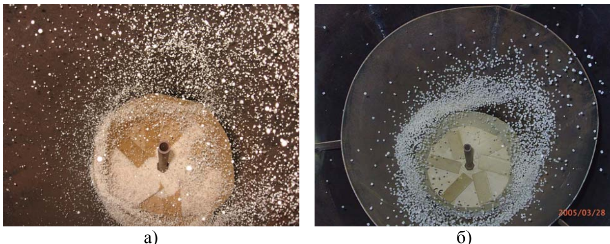
Рис. 4.5. Розподіл гранул в апараті за умови встановлення комбінованого газорозподільного вузла з завихрювачами: а) вихід на робочий режим ( G_{\text{ТВ}}=15 кг/год, Q_{\text{Г}}=600 м 3 /год); б) стабільний зважений шар ( G_{\text{ТВ}}=30 кг/год, Q_{\text{Г}}=1000 м 3 /год).
