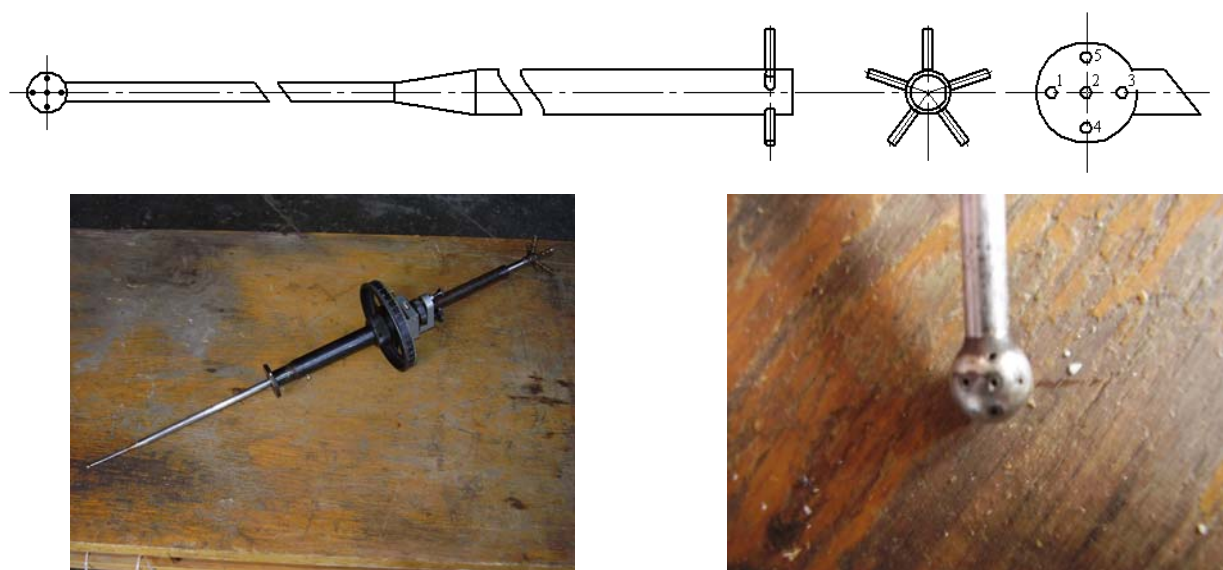
Рис. 2.8. 5- канальний аеродинамічний зонд з нумерацією отворів кульки.
