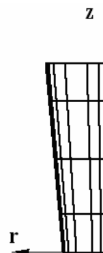
Рис. 3.11. Побудова розрахункової сітки для розв'язання математичної моделі. Рис. 3.12. Розрахункова сітка робочого простору вихрового гранулятора.
