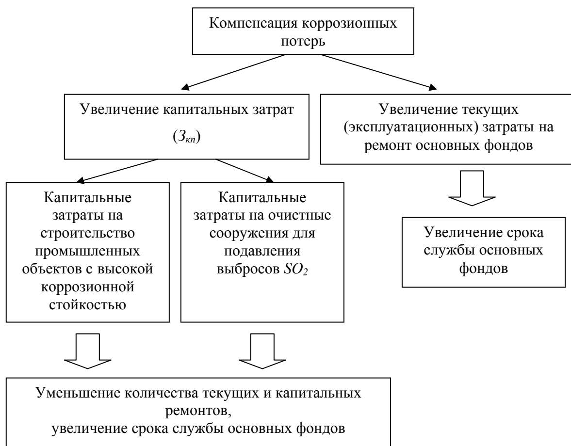
Рис. 3.7. Компенсация коррозионных потерь
