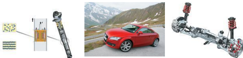
Рис. 8.8. Audi TT і підвіска із застосуванням магніторідинного амортизатора
