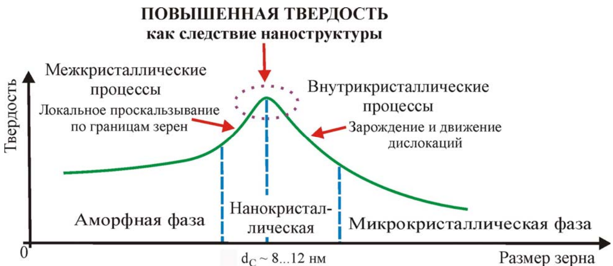
Рис. 1.1. Схематическое изображение зависимости твердости материала H от размера зерна [40]
