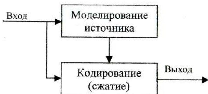
Рисунок 1 – Общая структура адаптивной системы сжатия информации
