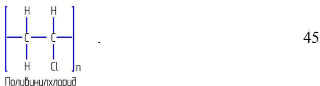
За счет полярности энергия межмолекулярных связей в поливинилхлориде больше, чем в полиэтилене. Поливинилхлорид, имея прочность при растяжении 100-200 МПа, прочнее полиэтилена (20-45 МПа). Полярные полимеры в отличие от неполярных имеют выше жесткость и теплоустойчивость, но ниже морозостойкость.
