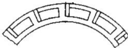
Рисунок 4 – Кольцо пары трения торцового гидродинамического уплотнения с плоской ступенью Релея
