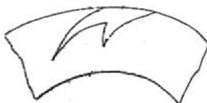
Рисунок 6 – Кольцо пары трения торцового гидродинамического уплотнения со спиральными канавками с разделительной перегородкой
