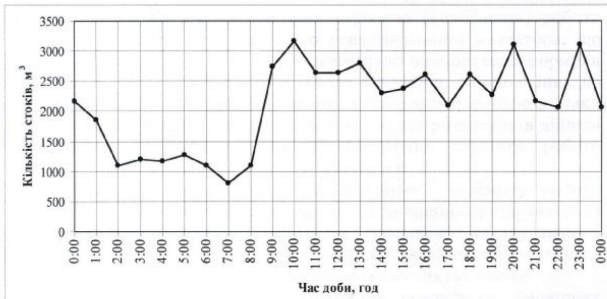
Рис. 2. Приклад графіка нахолження стоку на очисні споруди протягом доби
