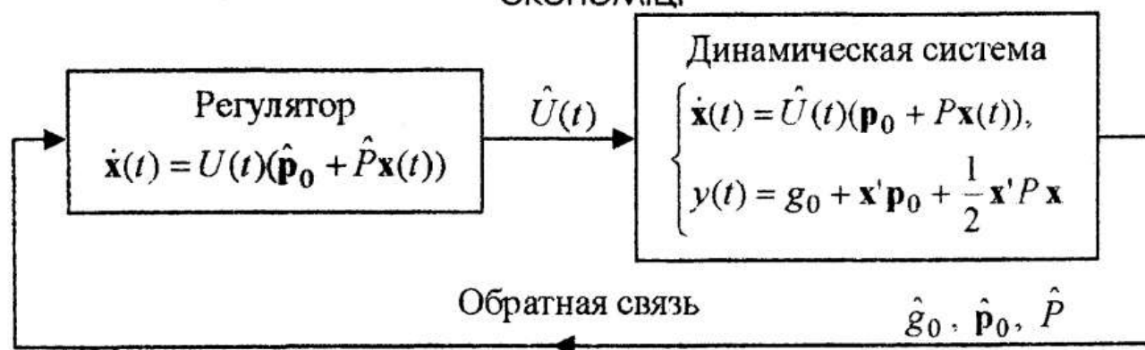
Рисунок 1. Схема функціонування системи з обратною зв'язкою
