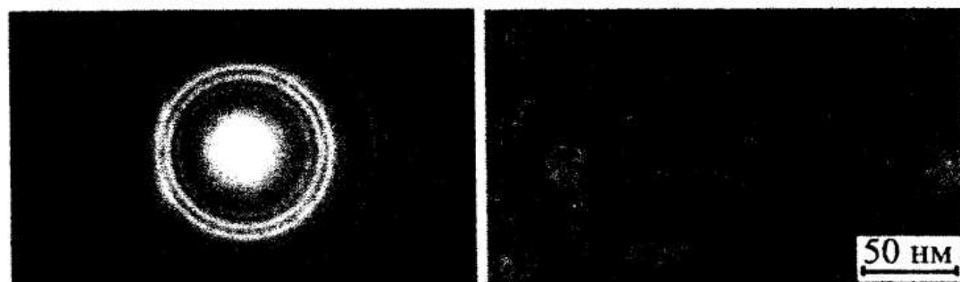
Рис.1. Електроннограма та кристалічна структура двошарової плівки Pd(4)/Fe(18)/П. В дужках товщина вказана в нм
