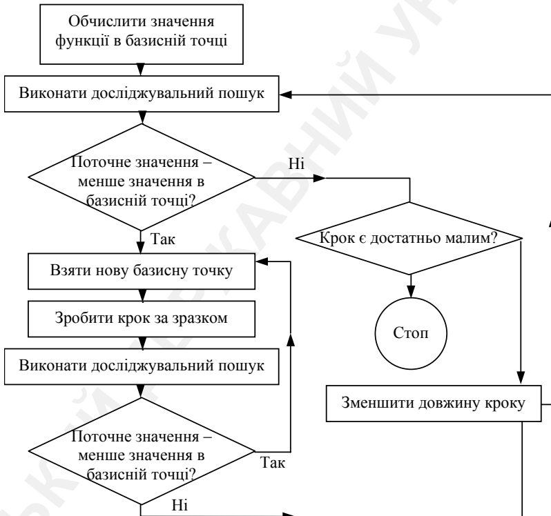
Рисунок 3.2 – Блок-схема методу Хука – Дживса
