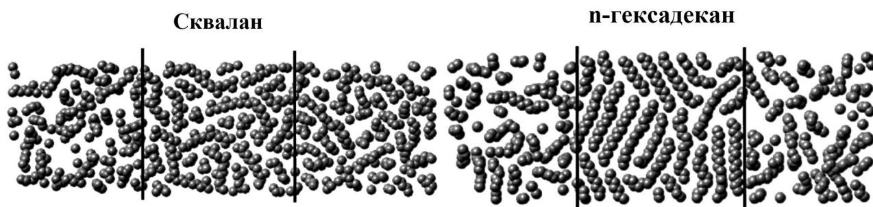
Рис. 1.2. Вид сверху граничных слоев сквалана (слева) и п-гексадекана (справа), соответствующих равновесным пленкам, содержащим 4 слоя. Сжатая жидкость находится в области между сплошными линиями. Можно отметить улучшенный внутри- и межмолекулярный порядок в пленке п-гексадекана [65]
