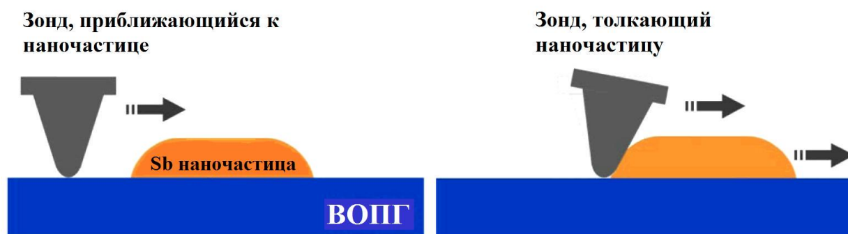
Рис. 1.11. Схема процесса манипуляции. Слева: зонд АСМ, сканирующий поверхность в контактном режиме, приближается к НЧ. Справа: зонд толкает НЧ вдоль пути сканирования. Дополнительный изгиб зонда наблюдается вследствие латеральной силы, действующей на него со стороны НЧ [46]
